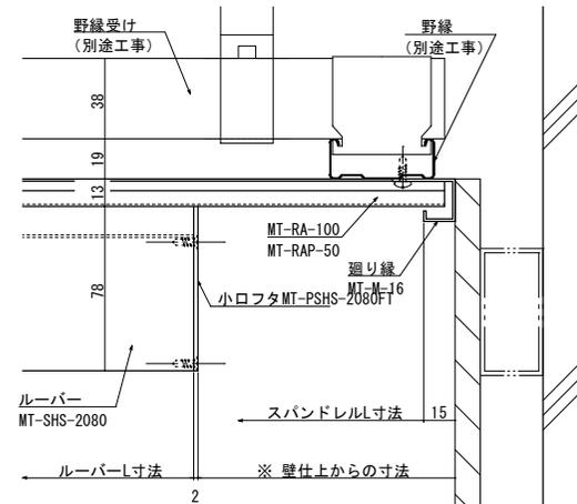
ルーバーを壁際まで取付ける場合は、廻り縁に突き付けず壁仕上面より30mm程度離すことをお勧めいたします。
